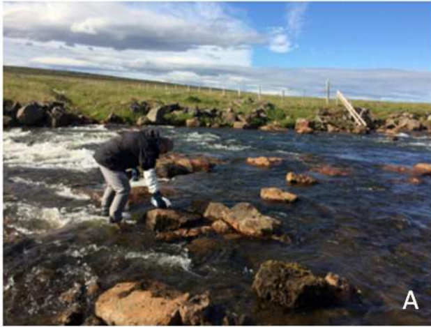
Mynd 3. Sýnataka í straum- og stöðuvötnum. A) Sýnataka í straumvatni: Sýnatökubrúsanum er beint upp í strauminn og sýnatökumaðurinn stendur fyrir neðan. B) sýnataka af bakka straum- eða stöðuvatna: Fötu í bandi er kastað vel út í vatnið og dregið í land. Í báðum tilvikum er mjög mikilvægt að ílátið sem sýnum er safnað í sé hreint og að óhreinindi frá nánasta umhverfi berist ekki í sýnið.
