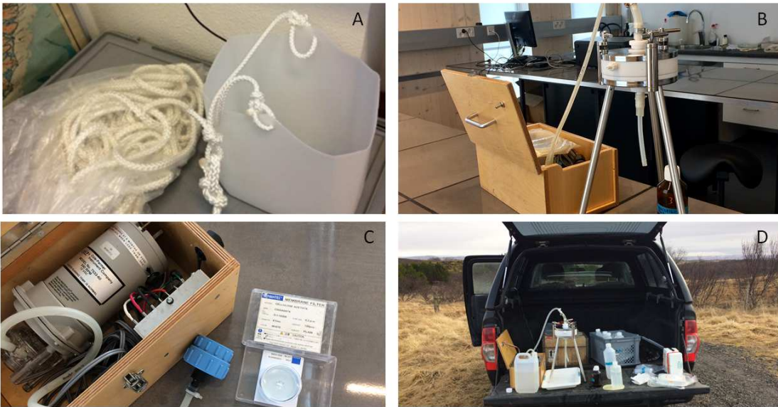
Mynd 2. A) Dæmi um sýnatökubúnað sem hægt er að notaða við vatnssýnatökur. Búið er að skera ofan af ónotuðum plastbrúsa sem er laus við öll litarefni. B) Stór síuhaldari (142 mm), peristaltísk dæla. C) peristaltísk dæla, in-line plast síuhaldari (47 mm) og viðeigandi síur. D) Dæmi um uppsetningu síubúnaðar í folti.
