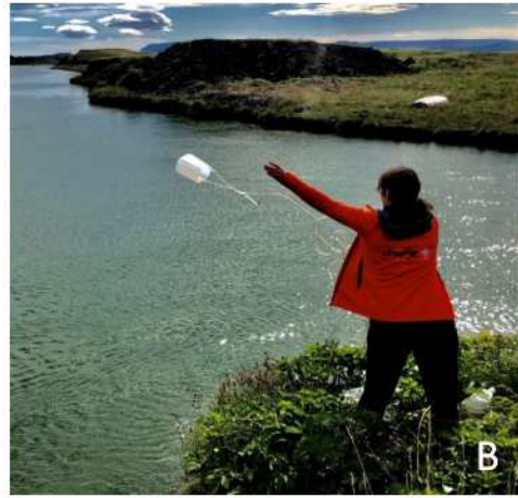
Mynd 3. Sýnataka í straum- og stöðuvötnum. A) Sýnataka í straumvatni: Sýnatökubrúsanum er beint upp í strauminn og sýnatökumaðurinn stendur fyrir neðan. B) sýnataka af bakka straum- eða stöðuvatna: Fötu í bandi er kastað vel út í vatnið og dregið í land. Í báðum tilvikum er mjög mikilvægt að ílátið sem sýnum er safnað í sé hreint og að óhreinindi frá nánasta umhverfi berist ekki í sýnið.
